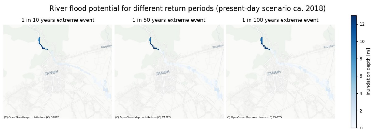
Figure 2-12 Ύψος πλημμύρας του ποταμού Κόσυνθου για περιόδους επαναφοράς ακραίων φαινομένων 10, 50 και 100 ετών.
